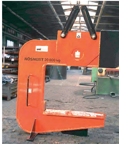
C-hák vyvážený CHV se závěsem pro dvojitý hák a s PU ochranami na kontaktních plochách
