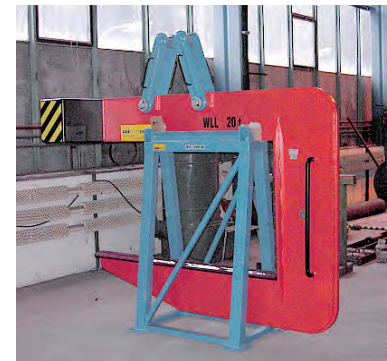
C-hák vyvážený CHV včetně odkládacího stojanu.
