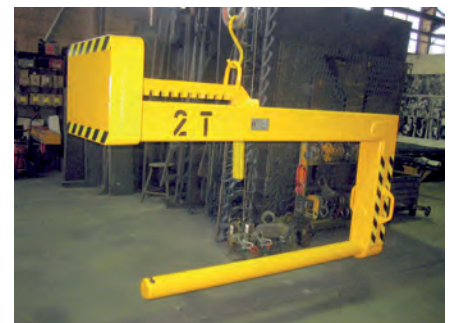
C-hák s protizávažím a přestavitelným závěsným okem
