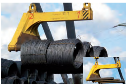
Speciální C-hák pro transport více svazků drátů. C-hák je opatřen třemi trny a uzpůsoben pro zavěšení na dva jeřáby.
