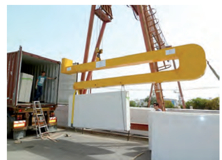
Speciální typ C-háku pro vykládku a nakládku materiálu z kontejnerů s čelním přístupem.
