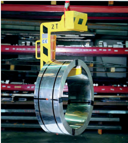
C-hák vyvážený CHV - kontaktní plochy jsou opatřeny ochranami proti poškození břemene a zvýšení adheze
