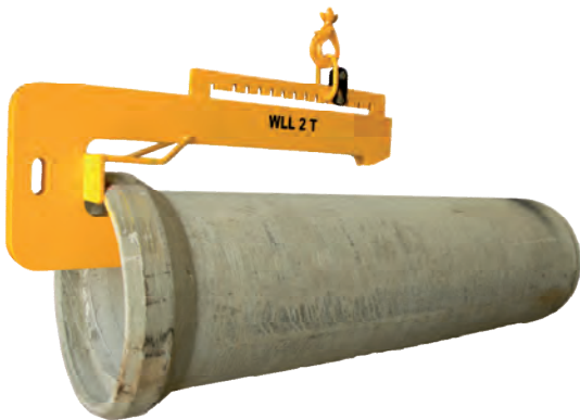
C-hák standardní (bez protizávaží) se stavitelným závěsným okem, určený pro manipulace s betonovými rourami různých délek.
