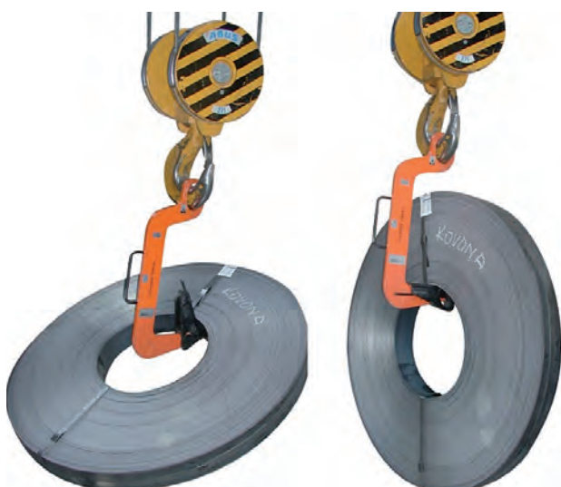
Překlápění svitku pomocí překlápěcího C-háku CHP
