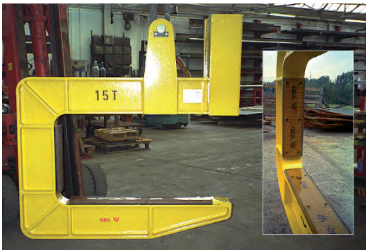
C-hák vyvážený CHV s čepovým závěsem. Kontaktní plochy jsou opatřeny ochranami proti poškození břemene a zvýšení adheze
