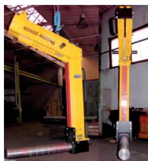
Vyvažovací C-hák s nosným trnem. Vyvažování se provádí přesouváním oka.
