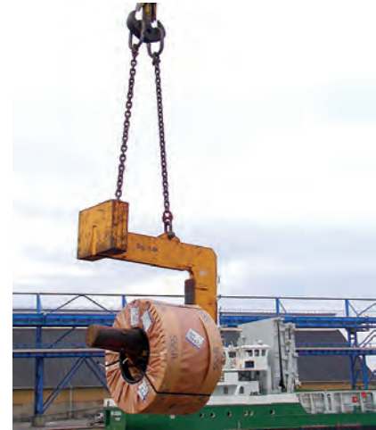
C-hák vyvážený CHV opatřený 2-pramenným řetězovým závěsem
