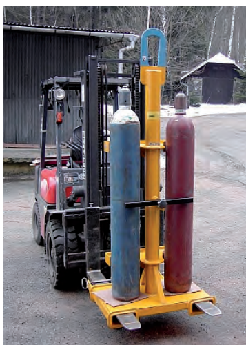
NLP2V - nosič 2 lahví na plyn při použití spolu s vysokozdvížným vozíkem.
