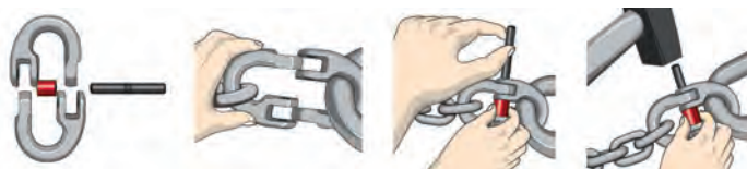
Montáž řetězového úvazku pomocí řetězové spojky CWI
