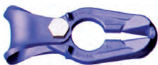
Lanový kluzný třmen Na jedné straně třmen pro snadné provléknutí lana a na druhé zkracovací lamela pro bezpečné uchycení řetězu JOKER V ø 7 nebo 8 mm v libovolné vzdálenosti.
