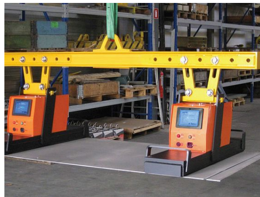
Speciální aplikace magnetů BM ve spojení s jeřábovou traverzou
