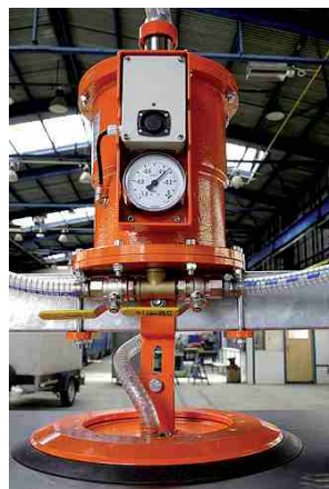
Detail uzavíracích ventilů pro vypínání/zapínání přísavek
