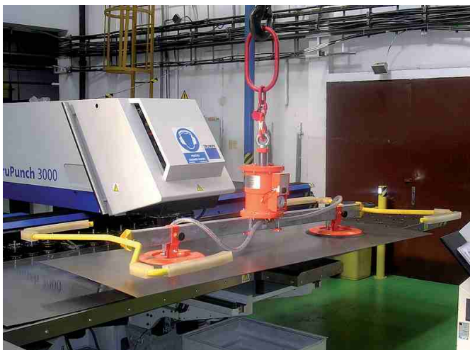
Standardní vakuový manipulátor VMS 600-2 dovybavený pomocnými madly pro snadnější manipulaci.
