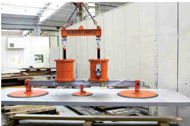
Vakuový manipulátor VMS s nosností 2400 kg se dvěma válci (2 x 1200 kg). Synchronní zdvih je zajištěn pomocí traverzy.
