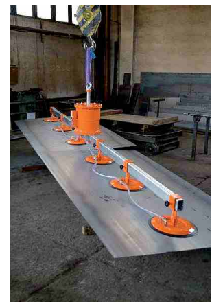
Manipulátor s nosností 500 kg, délkou 5 m, a s možností vypnutí 2x2 krajních přísavek.
