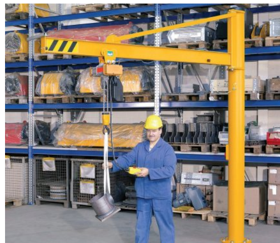
Sloupový jeřáb s pomocnou vzpěrou umožňuje použití méně robustního ramena, čímž usnadní obsluhu manipulaci. Nevýhodou může být snížení výšky ramena - zdvihu.
