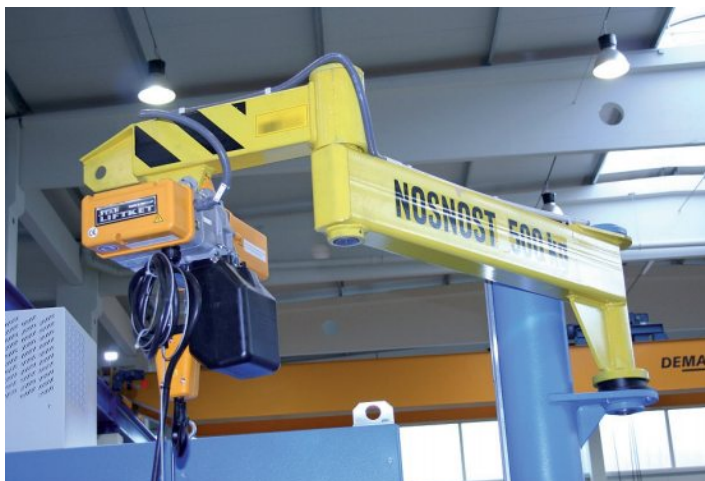
Speciální typ sloupového jeřábu s dvojitým kloubovým ramenem, které umožňuje zvětšení akčního rádiu jeřábu.
