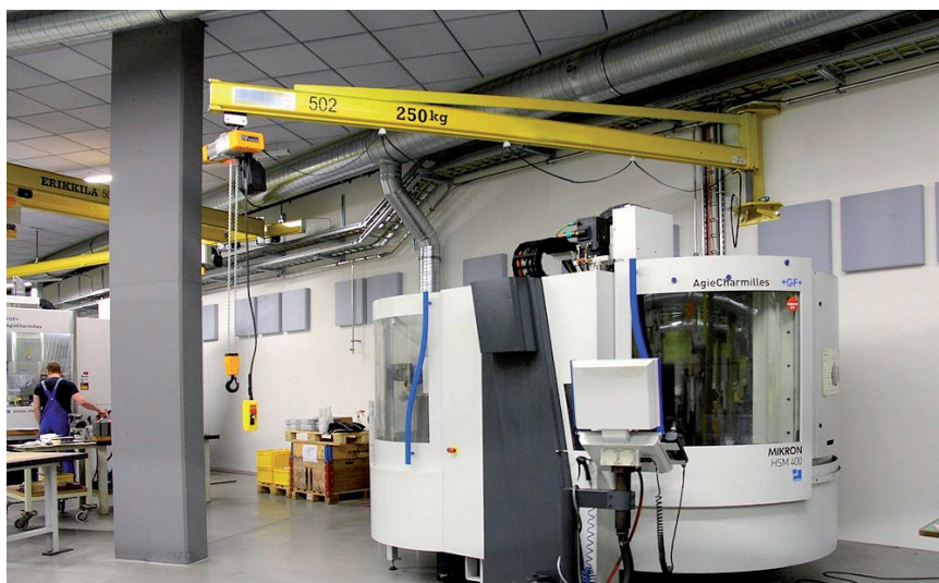
Konzolový jeřáb s pomocnou vzpěrou umožňuje použití méně robustního ramena, čímž usnadní obsluhu manipulaci. Nevýhodou může být snížení výšky ramena - zdvihu.
