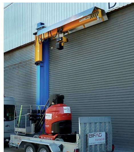
Konzolový jeřáb používaný ve venkovním prostředí s ochrannou stříškou.
