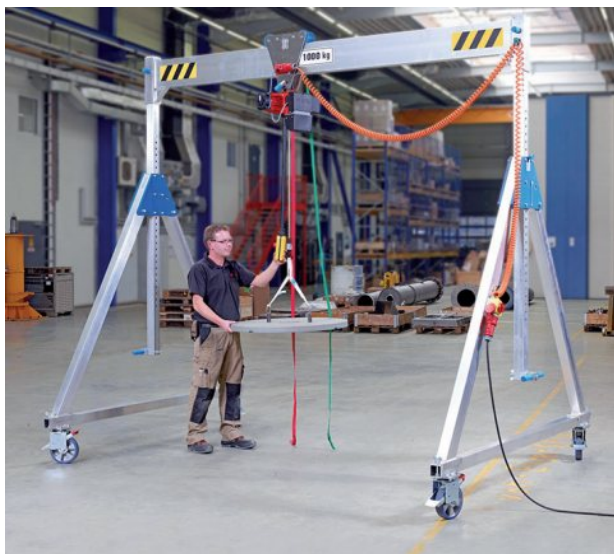
ALU portálové jeřáby s 1 nosníkem, nosnost do 1,5 t
