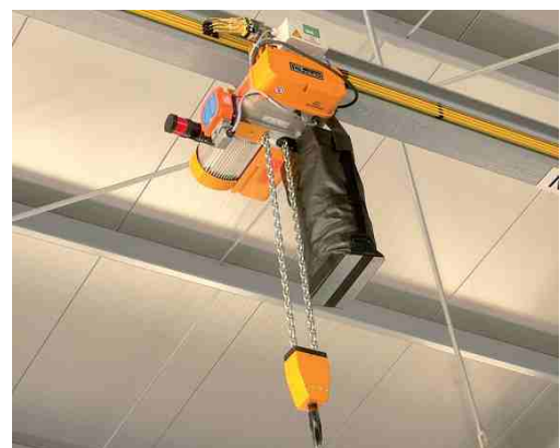
Jednorychlostní nebo dvourychlostní s rychlostmi pojezdu 4 m/min až 30 m/min, pojezd je brzděný
