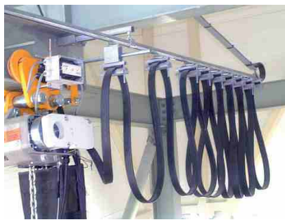
Kladkostroj LIFTKET s kabelovým shrnovacím vedením
