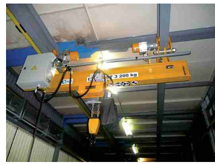
Podvěsný jeřáb s kladkostrojem STAR LIFTKET
