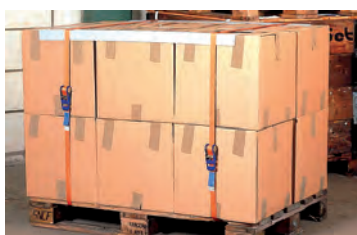
Svazkování pomocí jednodílných upínacích pásů ZPN
