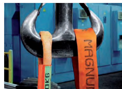
Srovnání smyčky Magnum-X se standardním typem se stejnou nosností
