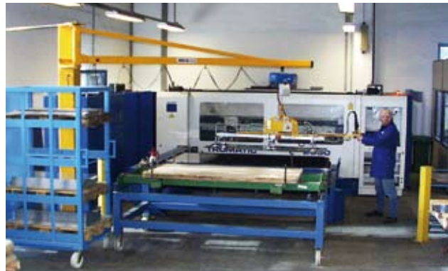
VacuBoy in Kombination mit einem Wandschwenkkran
