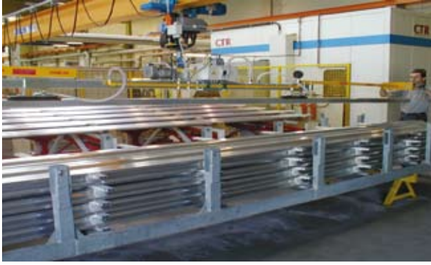
Tube beim Handling von Aluminiumprofilen
