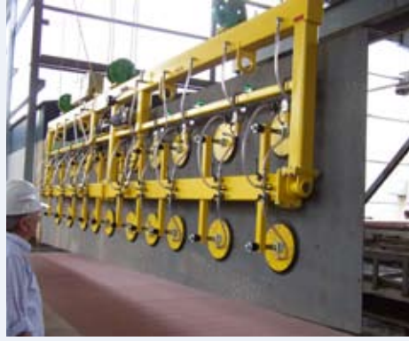
VacuGiant für die stehende Lagerung von Rohblechen in der Werft
