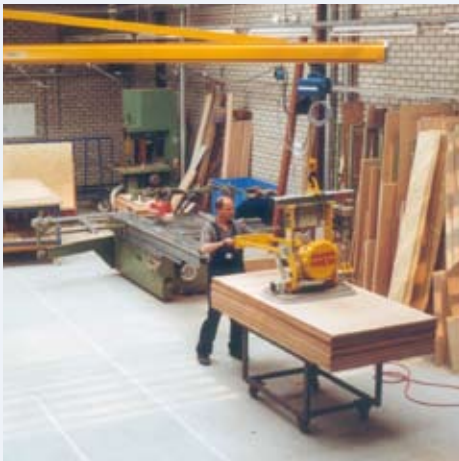
VacuPoro mit 90° Schwenkantrieb
