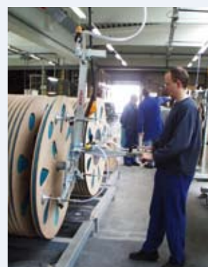
Vertikales Handling von Kabeltrommeln
