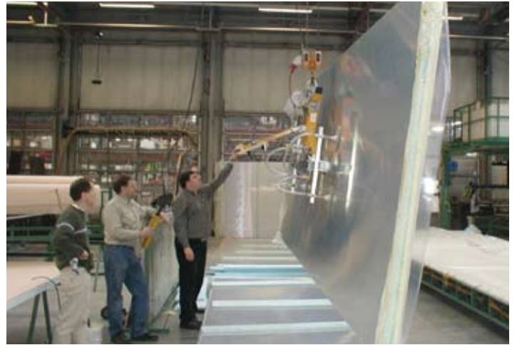
VacuBoy-90 beim Handling von folienumwickelten Sandwichelementen
