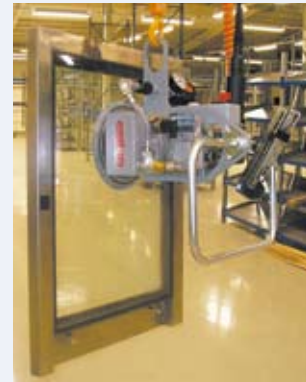
Handling von Fensterelementen
