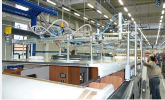
VacuBoy beim Montageprozess von Automobil-dächern
