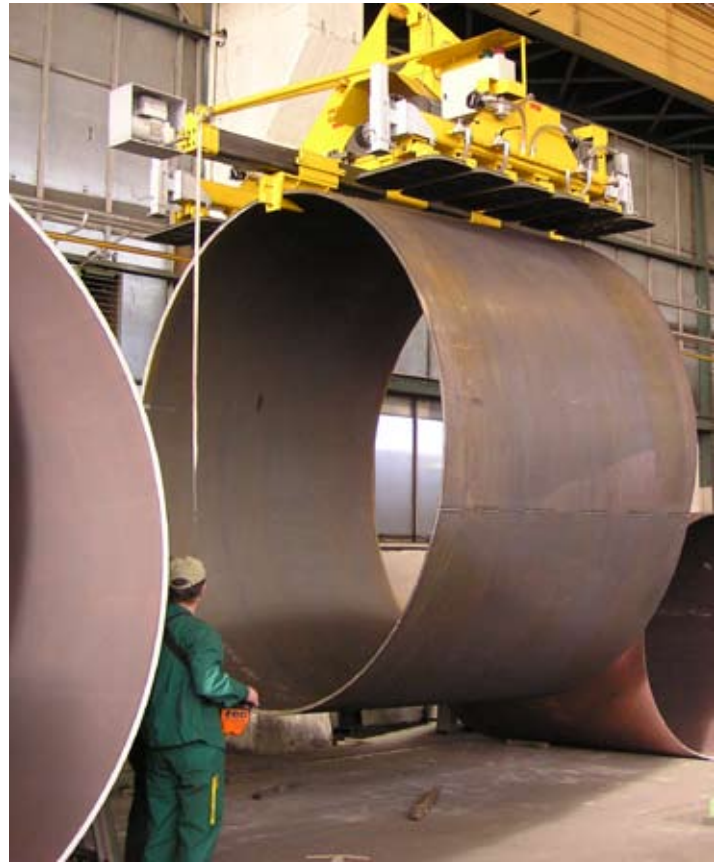
VacuGiant als „two in one“-Lösung. Handling von Stahlblechen und gerollten Rohren mittels mechanischer Greiflösung
