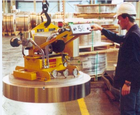
VacuCoil mit transparenter Saugplatte
