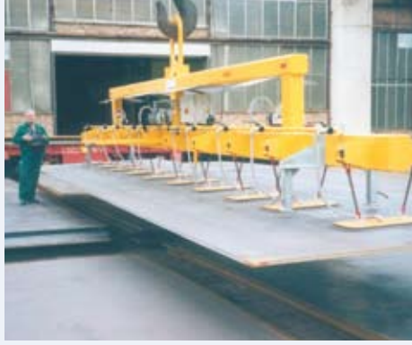
VacuGiant beim Stahlhandling
