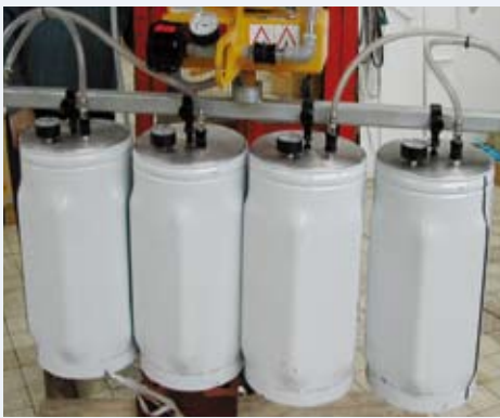
VacuBoy Mini mit Spezialaufsatz für das Fasshandling
