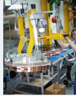
VacuCoil mit transparenter Saugplatte in der Kabelindustrie
