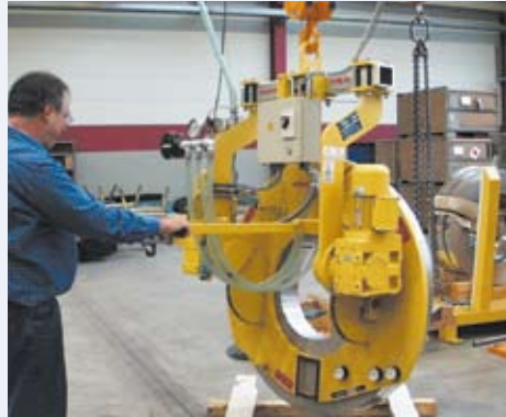
VacuCoil mit abgeflachter Saugplatte für die stehende Aufnahme von Coils mit unterschiedlichen Außendurchmessern
