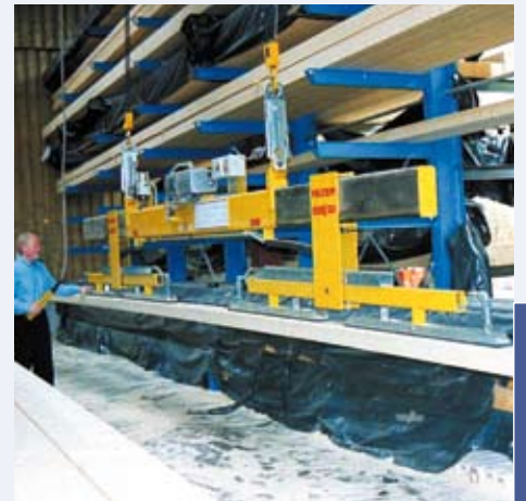
Kommissionieren von Leimbindern
