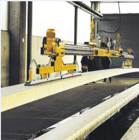
Handling von 24 m langen Leimbindern
