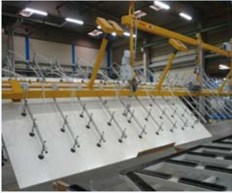
VacuGiant mit beidseitiger Schwenkvorrichtung und Gegengewicht für die exakte 90°-Stellung der Bleche
