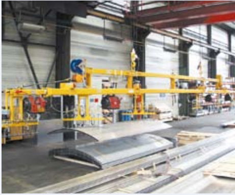
VacuGiant mit Kettenaufhängung für robusten Blechtransport
