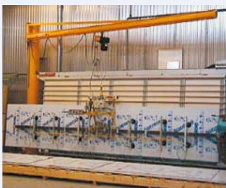
VacuBoy-90 beim Einsatz vor einer stehenden Aufteilsäge
