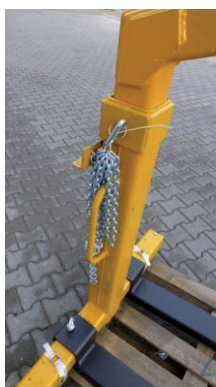
Zajišťovací řetěz pro zabezpečení břemene
