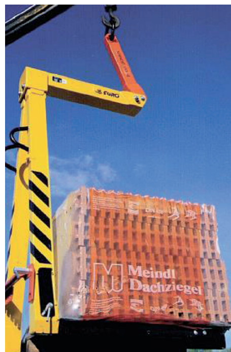
EZS EURO závěs samovyvažovací při manipulaci
