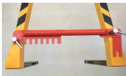
Změna rozteče vidlí se provádí pomocí stavitelného hřebenu
