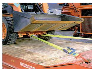
Přímé kotvení pomocí dvoudílných upínacích pásů ZPK
