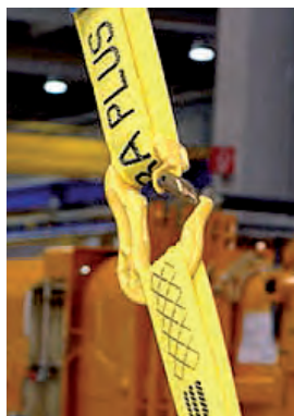
Spojení 2 smyček pomocí háku JOKER
